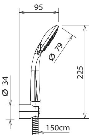
Les dimensions en millimètre sont sous réserve de modifications techniques, de tolérance et d'erreurs liées à la fabrication. La responsabilité ne peut être engagée en cas de côtes manquantes ou erronées.
