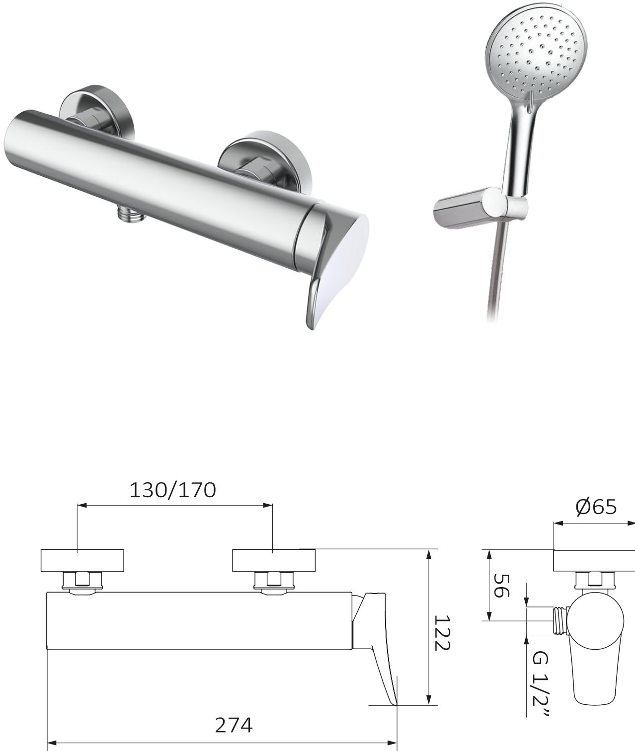
Les dimensions en millimètre sont sous réserve de modifications techniques, de tolérance et d'erreurs liées à la fabrication. La responsabilité ne peut être engagée en cas de côtes manquantes ou erronées.
