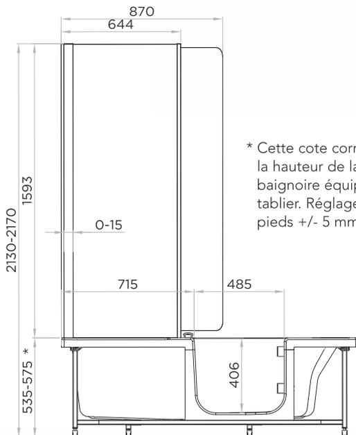
\* Cette cote correspond à la hauteur de la baignoire équipée d'un tablier. Réglage des pieds +/- 5 mm.
